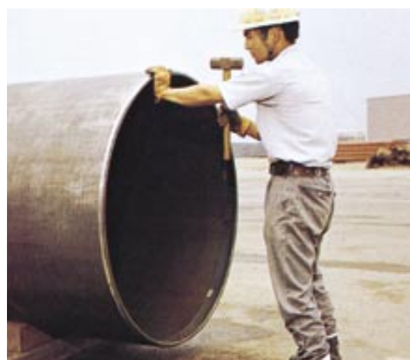
钢管端部斜边保护器的安装（安装顺序从上到下）
